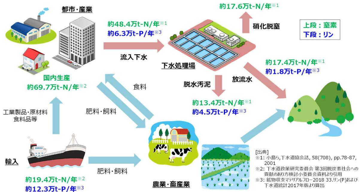
図 2-4 下水処理場を取り巻く窒素・リン収支
